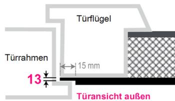
**13** Mindestens 1 mm + Aufbaustärke des Klebesystems. Die Breite der Abfällung beträgt generell 15 mm.
